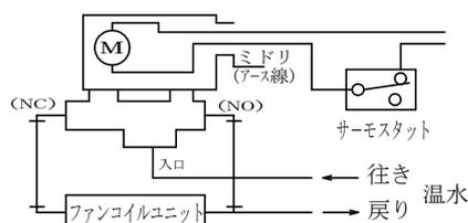
※温度上昇によりサーモスタットの検知温度が設定値に達すると3方弁はファンコイル側が閉となります。
