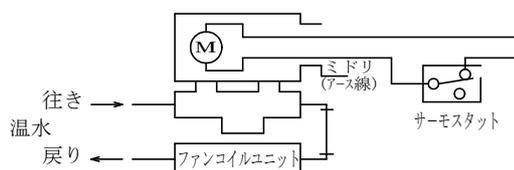
※温度上昇によりサーモスタットの検知温度が設定値に達すると2方弁は閉となります。
