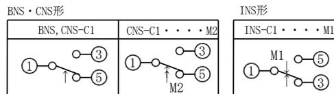
矢印↑は温度上昇時作動方向を示します。矢印↓M1は手動復帰方向を示します。矢印↑M2は手動復帰方向を示します。
