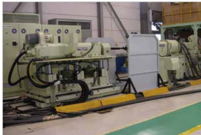
■ 驱动吸收型高速扭振试验机 用于对变速箱的磨损耐久, 异响评价的试验机 通过组合驱动马达, 高速扭振试验机, 和吸收侧的马达, 可以对变速箱施加回转, 动态扭转摇动的载荷试验 驱动马达 3000 rpm/4000rpm 196 N·m/148 N·m 扭振试验机 \sim 200 \text{ Hz} \ \text{max}1300\%/s 吸收马达 1000 rpm/4500 rpm 570 N·m/130 N·m
