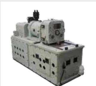
■ BPH-321-31 卡车用 (MT) 4000 rpm \pm 3.5 \text{ kN}\cdot\text{m} \pm 50^\circ 有恒温箱
