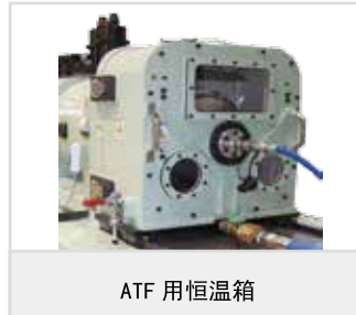
■ BPH-321-21 轿车用 (AT) 6000 rpm \pm 2.0 \text{ kN}\cdot\text{m} \pm 50^\circ 有 ATF 供油设备
