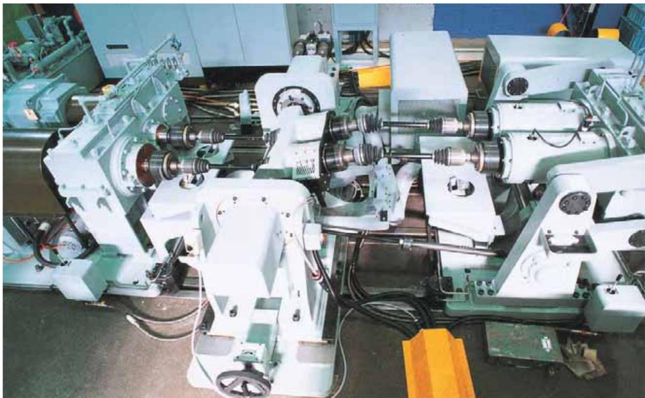
ドライブシャフトシミュレータは、実車状態における負荷条件を台上にて再現させ総合耐久試験を行います。CPUにより制御され伝達トルク、回転速度、車輪の上下摺動、及びハンドル切れ角度（ステアリング角）などの諸条件を組み合わせて耐久性を評価できます。又、車軸での生データをCPU（パソコン）に記憶させ、実車波形を組み合わせた試験も可能です。
